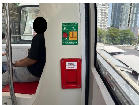
รูปที่ 2-16 สัญญาณฉุกเฉินบนขบวนรถไฟฟ้า
